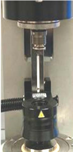
Figur 46 - värmekåpan precis innan den ska omsluta spindel och plattan.
