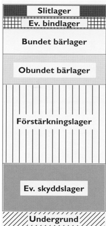
Figur 1- Principiell uppbyggnad av en överbyggnad (Wiman & Tholén, u.å).
