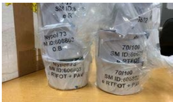
Figur 37- Tre varianter av respektive bitumensort (O.B originalbitumen, RTFOT, RTFOT+PAV), totalt 6 aluminiumbehållare.
