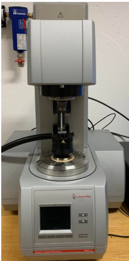
Figur 34 - Dynamisk skjuvreometer av märke Anton Paar modell MCR 302.
