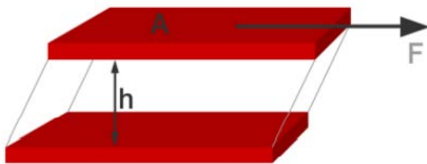
Figur 12 - Illustration av två-platt modellen (Paar, 2022b).
