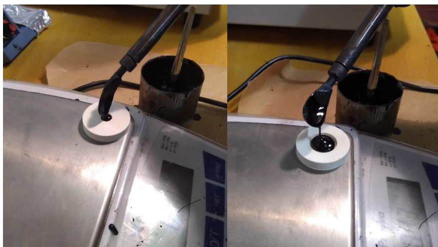
Figur 3.1-3 - Uppvägning av material för provkroppar, PP08 och PP25
