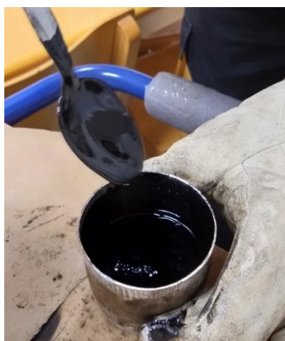
Figur 3.1-2 - Blandning av bruk och bitumen med uppvärmdsked
