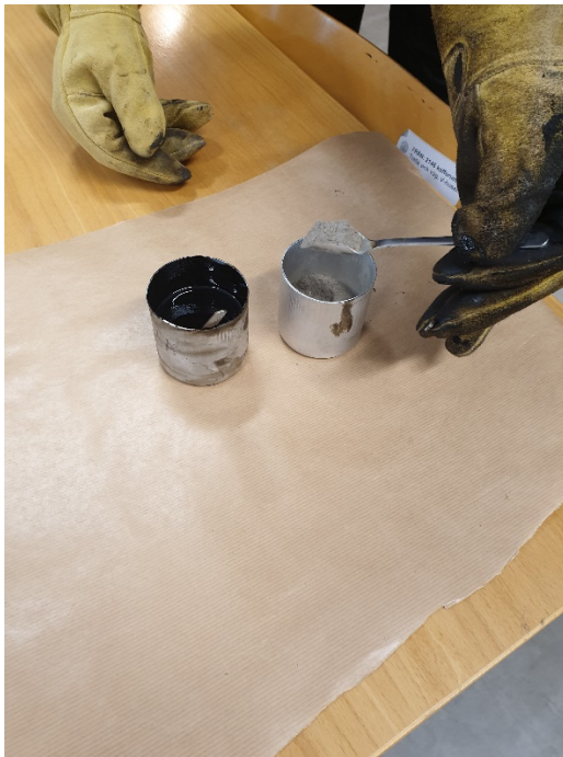
Figur 19 Filler matas in i omgångar i bitumen.
