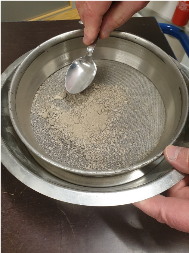
Figur 13 Filler med klumpar på sikt 0,125 mm.
