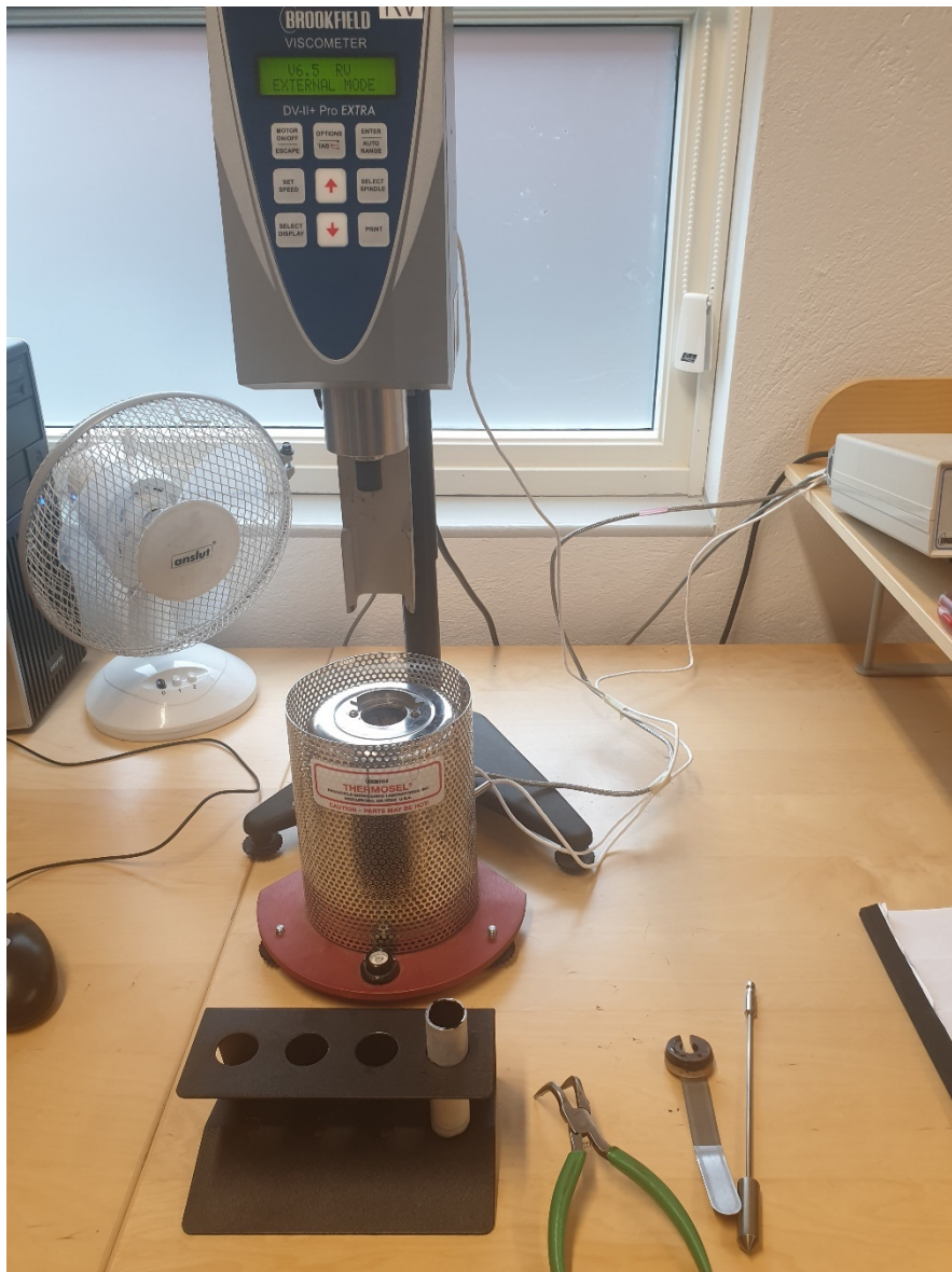
Figur 2 Rotationsviskosimeter, RVB med tillhörande värmeelement, spindel, lock, tång samt provrör med provrörshållare
