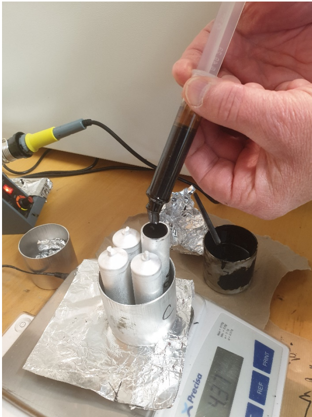
Figur 24 Asfaltbruket sprutas ner i provrören
