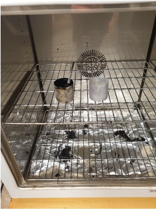
Figur 17 Bitumen och filler i ugn för uppvärmning.
