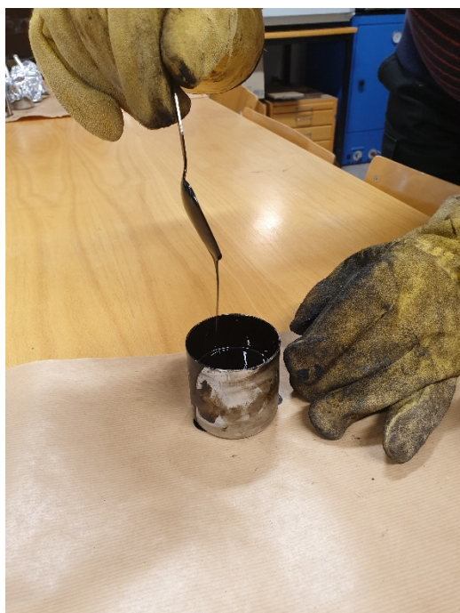
Figur 21 Homogen blandning av filler och bitumen
