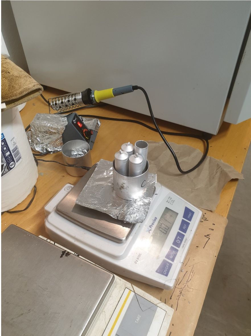
Figur 11 Provrör i burk vid uppvägning på våg med noggrannhet 0,01 g samt tillhörande värmesked
