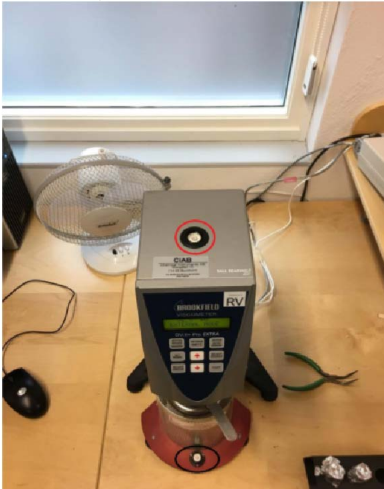
Figur 30 Vattenpass på RVB och värmeelement [31]
