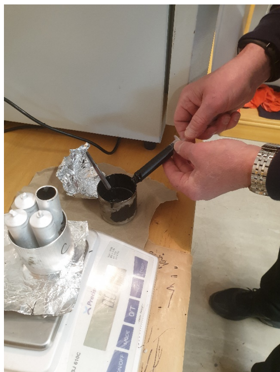
Figur 23 Uppmätt mängd asfaltbruk i spruta
