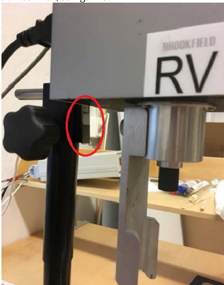
Figur 29 Spak för höjning och sänkning av spindel [31]
