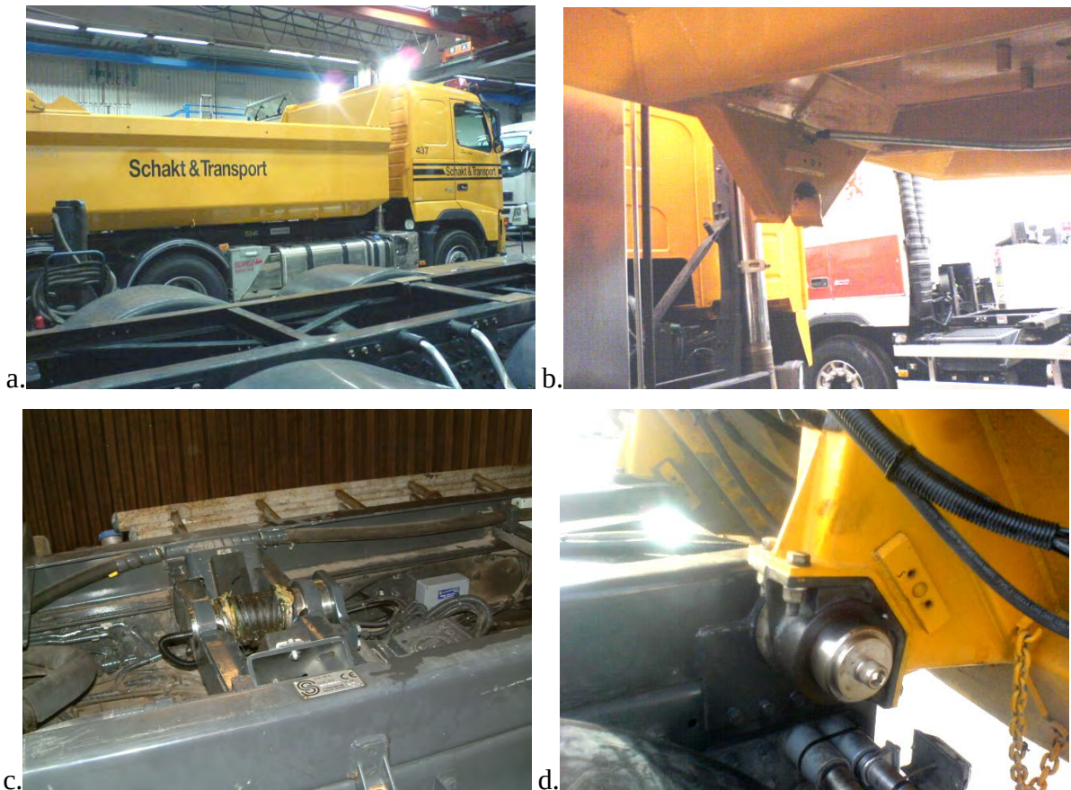
Bild 3-1 Boggilastbil med tipp på verkstaden i Växjö. Lastgivarna placerades framtill (c.) under lastflakets främre klyka (b.) och baktill i flakets tippbom (d.).
